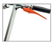
PRISE DE L'HOMME MORT La machine est équipée d'un dispositif d'homme mort.
