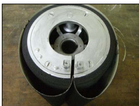
Fig.3-Mise en place de l'abrasif
