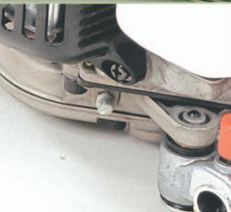
Entretien aisé - Ici accès faciles au filtre à air et au graisseur sur le réducteur
