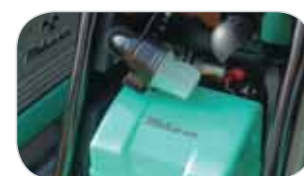
FILTRE CYCLONIQUE POUR MVH 306 DS, 406 SDS. AUGMENTE LA LONGÉVITÉ DU MOTEUR
