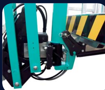
Faible encombrement du groupe flèche qui reçoit la cellule de chargement et rotation du panier
