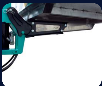
Attache panier pour effectuer un montage rapide
