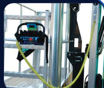
Commande filaire unique pour manipulation bas et haut.
