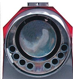
Chambre de combustion nouvelle génération (ITA 45/75).
