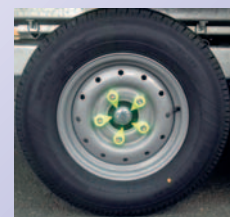
Indicateurs de desserrage de roue
