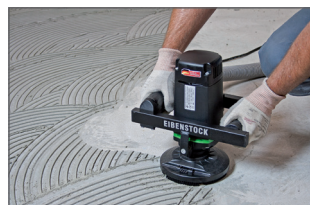
Poignées placées en parallèle pour + de confort et de stabilité
