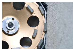
Avant du carter amovible pour le ponçage au ras du mur
