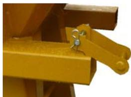
Système de verrouillage de fourches
