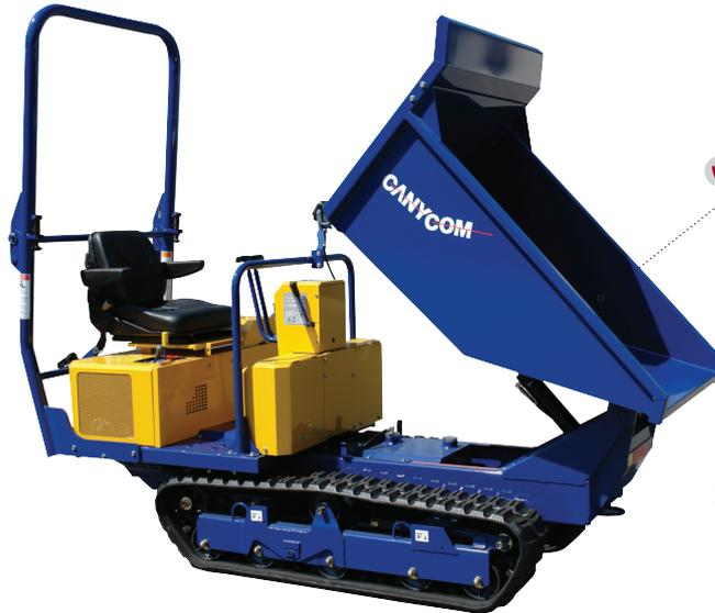
✓ Benne à basculement frontal à 90°
