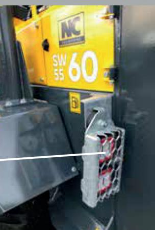
Capot arrière de 15 mm d'épaisseur pour une protection maximale contre les chocs
