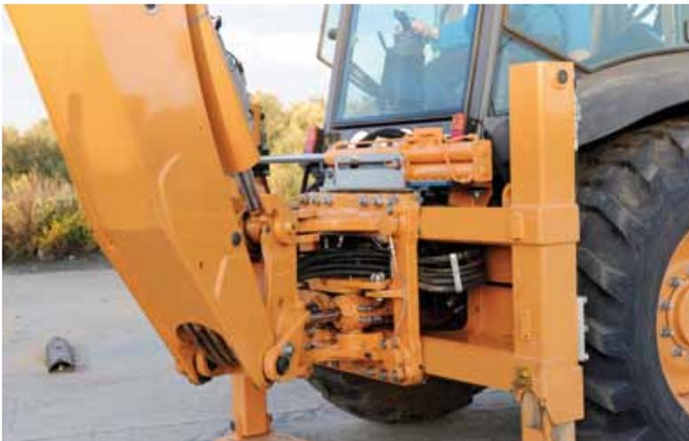
Attache rapide mécanique en standard ou hydraulique en option.
