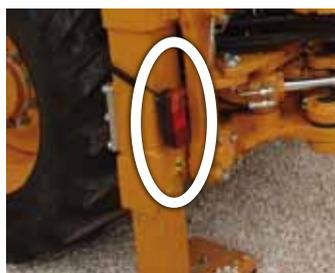
Les feux arrière peuvent être montés sur les stabilisateurs pour le transport et sur la cabine dans une position protégée pendant les travaux.
