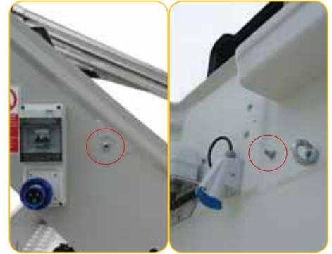
■ Prise électrique de série sauf pour modèles P13T7 et P16T9 (option)
