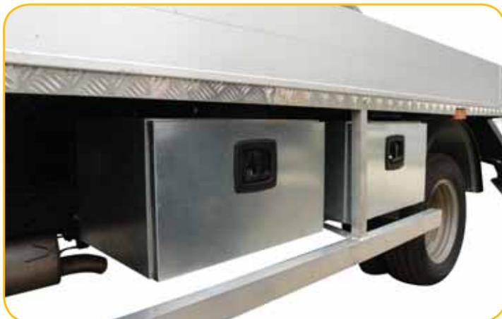
■ Coffre (option) - 1 coffre de série sur les modèles P14T9 / P18T12 / P21T10 / P19AS10
