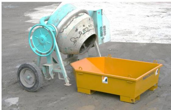
2 Anneaux d'élingage en partie basse arrière pour un basculement complet et un vidage optimal.
